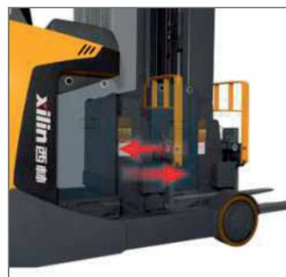
La batteria può essere rimossa con il montante e adotta una struttura laterale per facilitare la manutenzione o la sostituzione della stessa.
