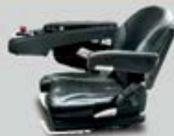
I sedili a sospensione integrale Grammer sono opzionali per una guida più confortevole. Il bracciolo multifunzionale integra interruttore a sfioramento, interruttore dello sterzo, cambio PES, pulsante clacson, interruttore di spegnimento di emergenza, ecc., facile da usare e controllo proporzionale elettromagnetico preciso.
