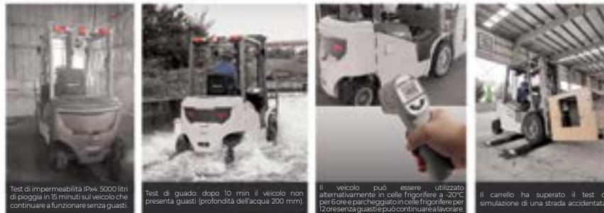
Test di impermeabilità IPx5, 5000 litri di pioggia in 15 minuti sul veicolo che continuano a funzionare senza guasti.
