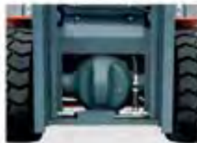
Asse motore: tamburo del freno interno, alloggiamento dell'assale in fusione integrale, design del paraolio semialbero, ampio grado di coincidenza e ingranaggi ad alta precisione
