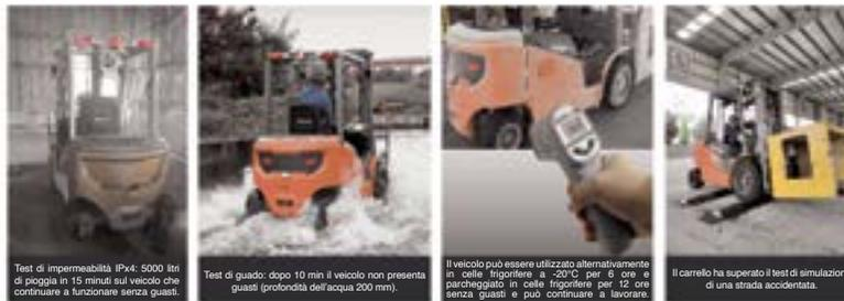
Test di impermeabilità IPx4: 5000 litri di pioggia in 15 minuti sul veicolo che continuano a funzionare senza guasti.
