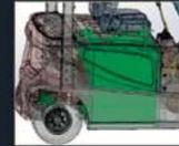
Disposizione centrale del vano porta batteria
