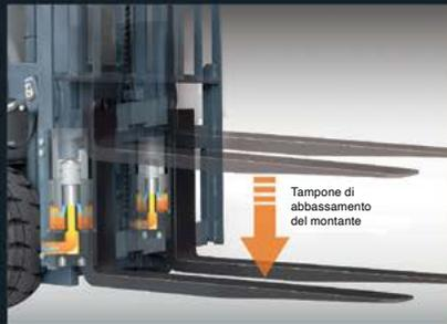
Tampone di abbassamento del montante
