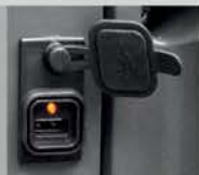
La maniglia posteriore e l'avvisatore acustico sono progettati per le operazioni di retromarcia più sicure.
