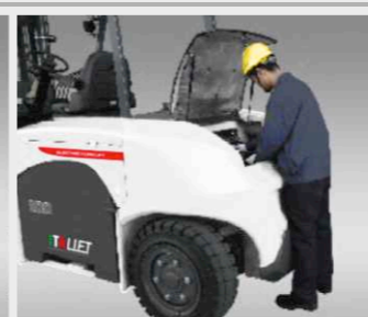
Quadro elettrico di facile accesso con chiusura d'emergenza
